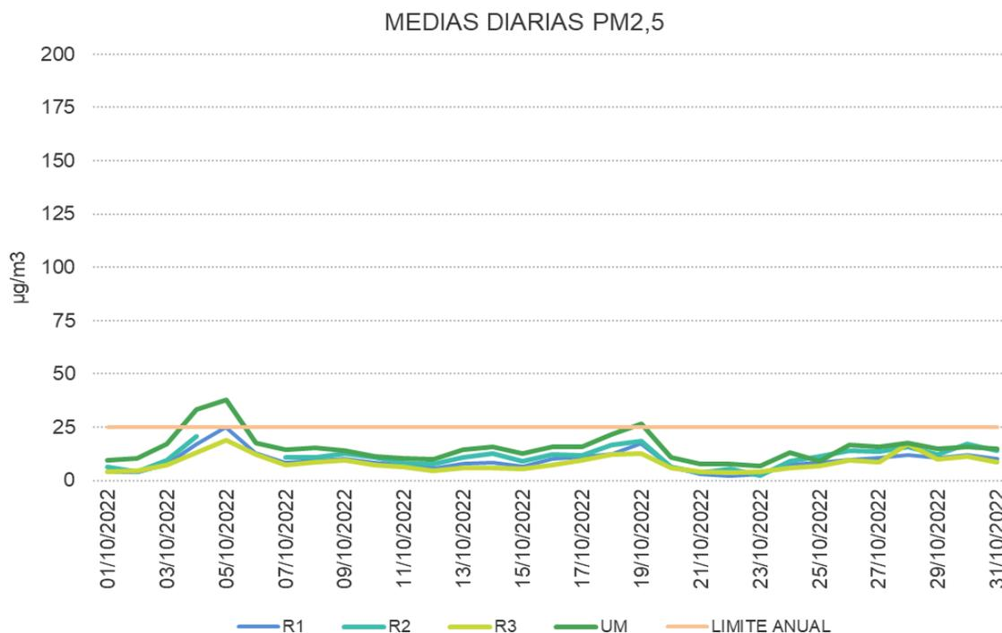
Los días 5 y 6 de octubre se pierden datos del analizador de PM2,5 debido a un fallo en la bomba del equipo.
