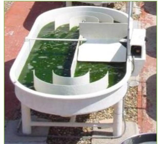
*Reactor abierto raceway*
