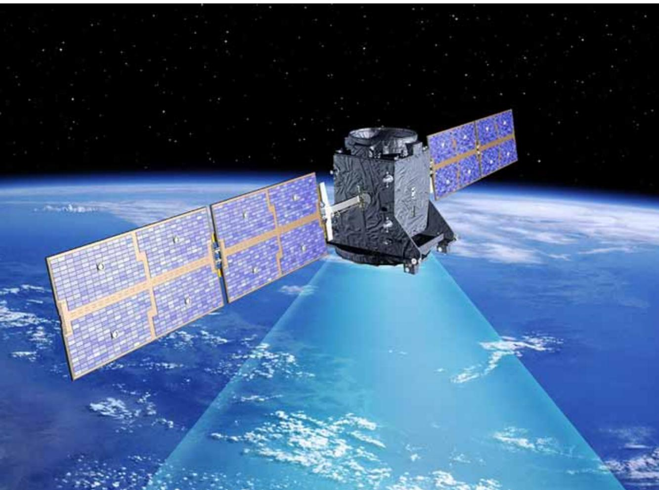
La solución EGNOS, sistema europeo de aumentación de navegación facilita el guiado de las aeronaves y funciona como complemento del sistema americano GPS. EGNOS incrementa la precisión de la señal GPS y facilita el guiado de las aeronaves con información de posición tanto horizontal como vertical, mejorando la precisión de 10 a 2 metros y emitiendo un mensaje de aviso que informa al piloto en caso de fallo del sistema.
