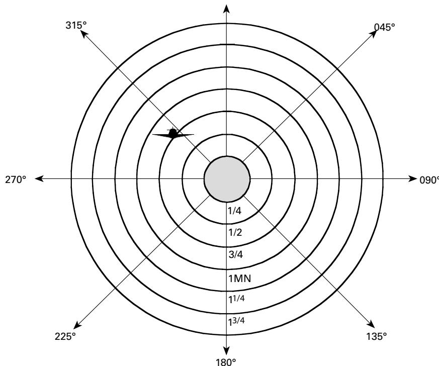
Situar la posición de una de las aeronaves implicadas en el centro del gráfico e indicar su rumbo sobre el correspondiente radio del círculo.
